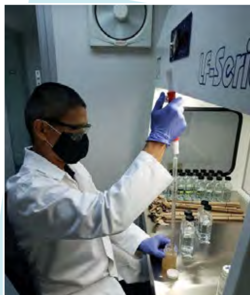
Análisis de muestras de aguas residuales domésticas y de sentinas en las Plantas de Tratamiento de Aguas Residuales de los Remolcadores AF-20
